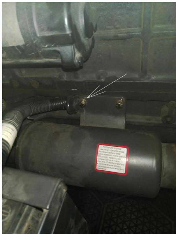
Рисунок 13 – Подсоединение провода(синего) к массе трактора
