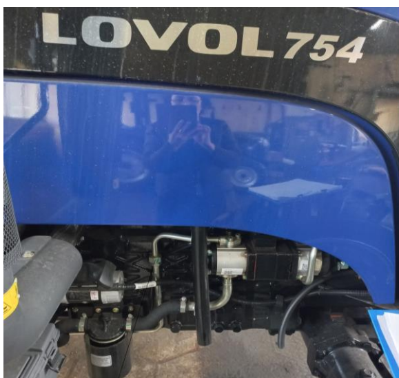
Трубка от масляного насоса к распределителю трактора
