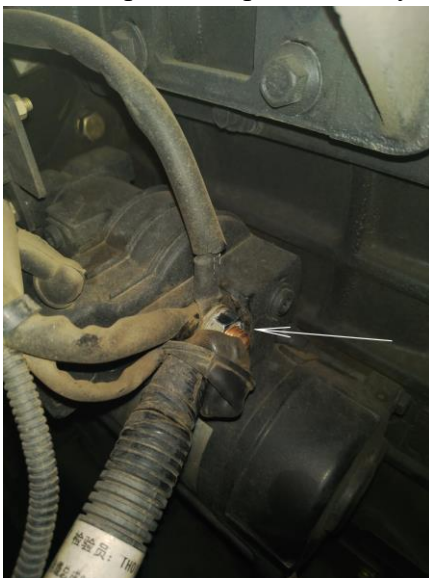
Рисунок 12 – Подсоединение провода(коричневого) к «+»стартера:
