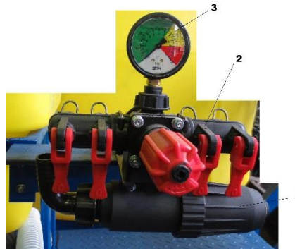
Рис.10 Регулятор-распределитель с напорным фильтром.
