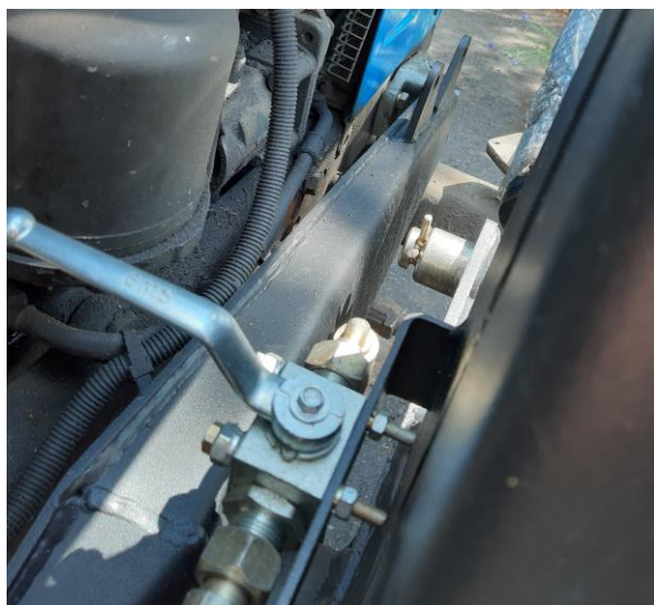
Рис.50 Установка крана двухходового
