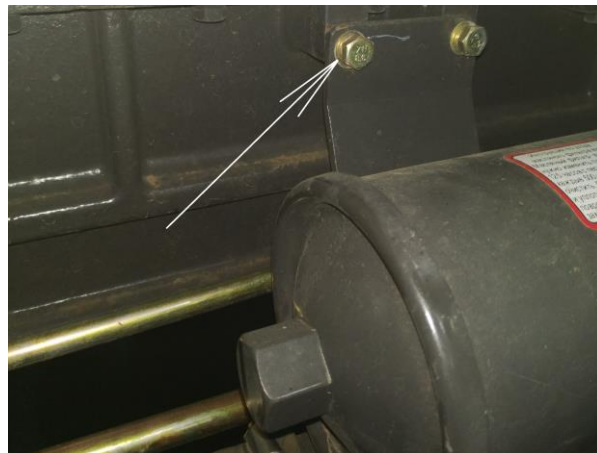
Рисунок 13 – Подсоединение провода(синего) к массе трактора
